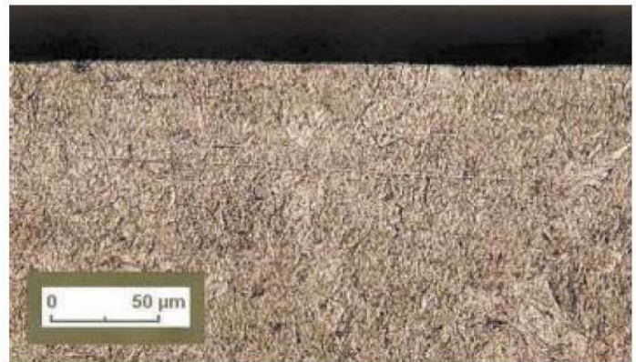
Поверхность после фрезерования твердосплавным инструментом Surface finish following milling with carbide tool
