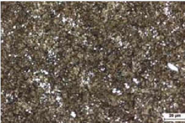
BOHLER S600 Hardness / Твердость: 65,9 HRc
