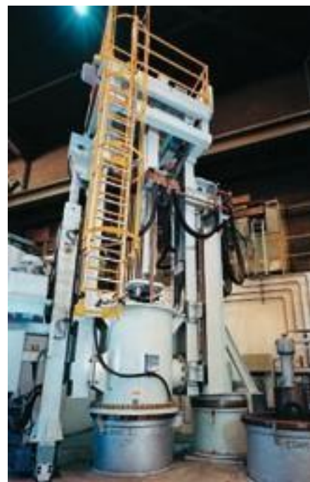
VAR – Vacuum Arc Remelting Furnace ВДП – Печь вакуумного дугового переплава
