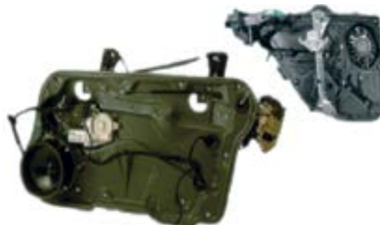
Дверной модуль из пластика, армированного длинным волокном Источник: M. Schemme, FH Rosenheim
