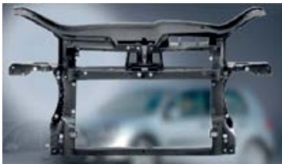
Передняя часть кузова автомобиля из пластика, армированного длинным стекловолокном Источник: M. Schemme, FH Rosenheim
