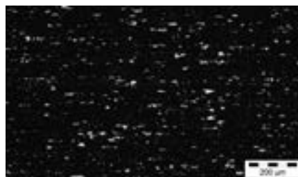
Микроструктура стали качества ЭШП с 8%-ным содержанием хрома
